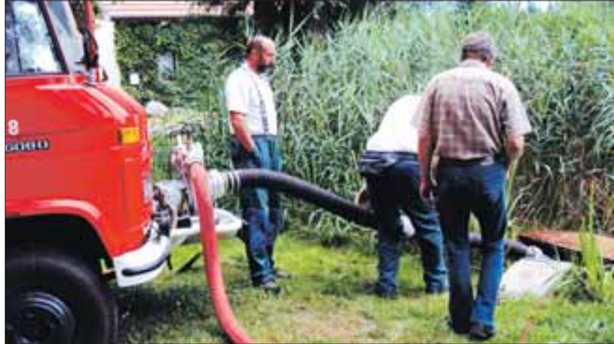
Wasserentnahme mit LF 8 der Feuerwehr
