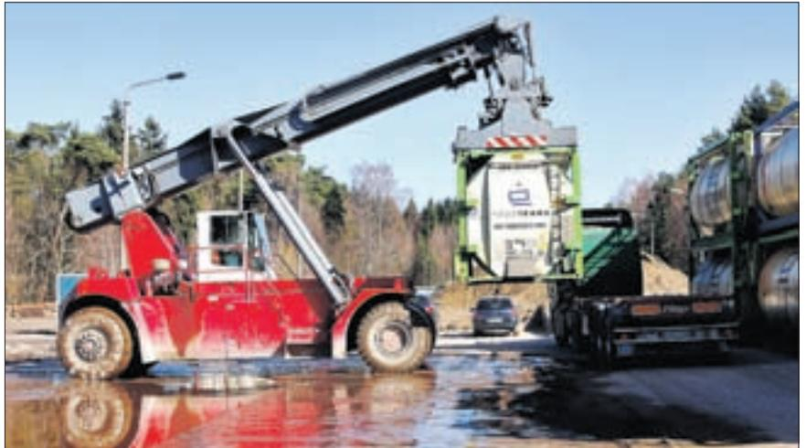
Für die Be- und Umladung von Schiene auf LKW bzw. umgekehrt ist spezielle Technik erforderlich. LOCON, die im Auftrag der Gemeinde Pinnow die Anschlussbahn betreiben, setzen für die Container-Verladung Schwertransportstapler (Reachstaker) ein, welche im beladenen Zustand ein Gewicht von ca. 100 t aufweisen. Im Vordergrund sind die Rangierflächen zu sehen, die befestigt werden.
